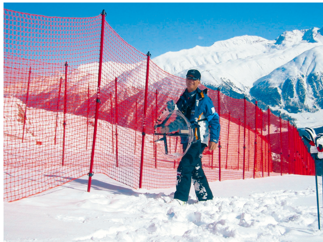
RF-condensatormicrofoon gebruikt bij buitenuitzendingen
